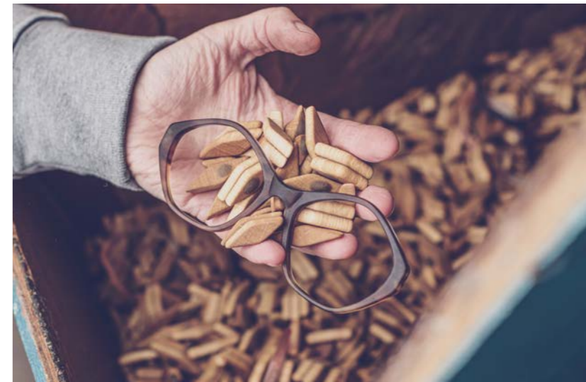
(Foto rechts) Hochwertiges Material: Ein wichtiger Fertigungsschritt bei Acetatfassungen ist das Grob- und Feinschleifen und Polieren in eigens dafür vorgesehenen Trommeln. (Foto unten) Bewährte Technik: Unter den 28 Maschinen sind Drehstromautomaten mit einfacher Kopierfrästechnik und weitere Geräte für einzelne Arbeitsschritte.
