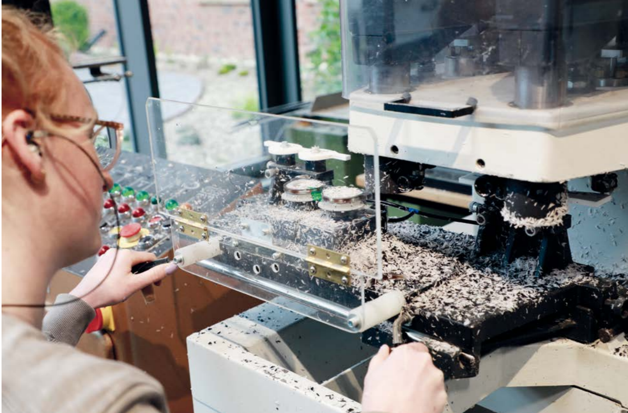
Ob Holz oder Acetat: Sarah Mersmann kennt die handwerkliche Verarbeitung beider Materialien, das Bohren, Fräsen, Schleifen. Bei einer Acetatbrille brauche es mehr Fingerspitzengefühl, die Formen seien filigraner, sagt die gelernte Tischlerin. (Foto unten) Ein gutes Auge, Erfahrung und Feingefühl zeichnen auch Augenoptikerin Katja Greiwe aus, hier bei der Handpolitur einer Acetatfassung.
